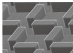
バイオセンサー金型と電鍍にて製作
